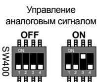
При стандартной настройке электроприводы EZxxxx KL XX 123 A0 работают с управлением по аналоговому сигналу.
