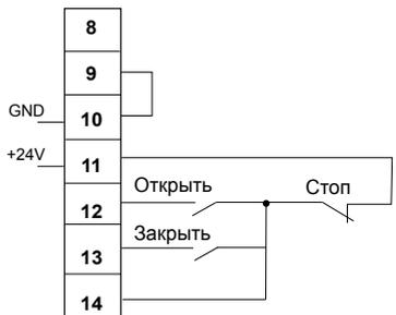
Импульсный сигнал управления
