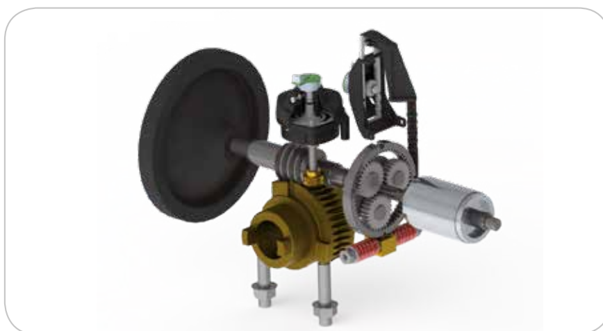
BERNARD CONTROLS Positions- und Drehmomentsensoren sind mechanisch mit der Abtriebswelle verbunden.
